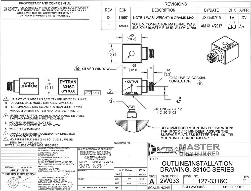
Model Number DOC NO PERFORMANCE SPECIFICATION 3316C PS3316C SINGLE AXIS CHARGE MODE ACCELEROMETER REV H, ECN 14095, 03/14/18
